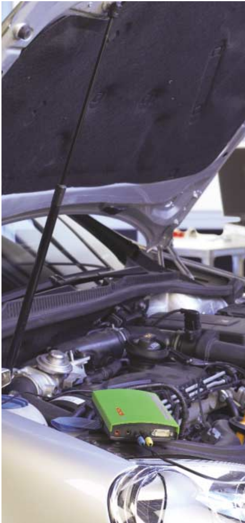
Steuergeräte-Diagnose in der Werkstatt mit Funktechnik bis 100 m Reichweite
